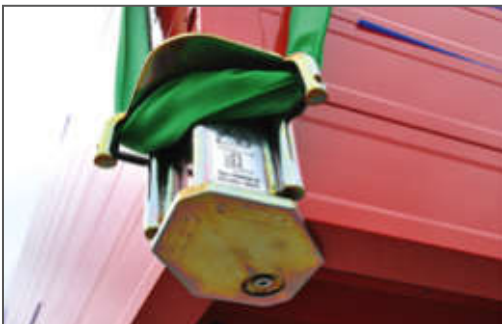
Abb. 12: Detailansicht: Eingebautes Transportgehänge am Elementstapel
