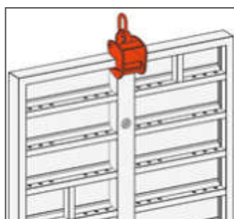
Abb. 20: Kranhaken über Mittelholm
